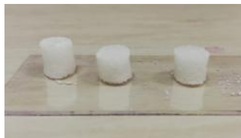
Слика 29. а) Полимерна пена након потапања у пасту б) скафолд после синтеровања [61]
