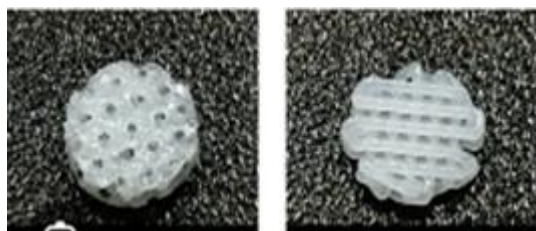
Слика 33. 3D хидрогел скафолд на бази а)PCL б)PCL/НyА [68]
