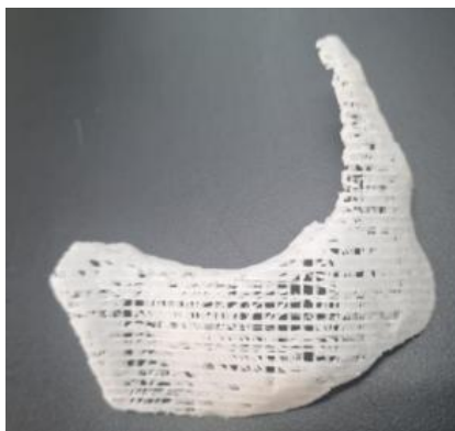
Слика 34. 3D скафолд PCL/ \beta -TCP [70]
