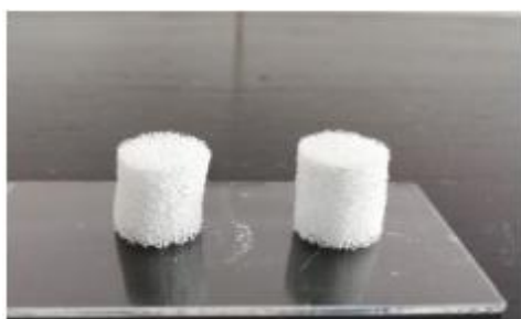
Слика 29. а) Полимерна пена након потапања у пасту б) скафолд после синтеровања [61]
